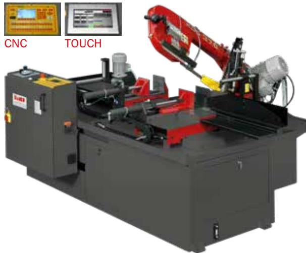
Segatrice a nastro completamente automatica comandata da CNC per il controllo di tutte le funzioni macchina. Rotazione arco e carro alimentazione materiale automatici comandati da motori brush-less. La versione "touch" è dotata di pannello di comando touch screen da 7". Carter perimetrali di protezione, doppio pulsante start per avviamento ciclo e impianto elettrico in bassa tensione secondo normative CE. La macchina può essere fornita con caricatori automatici e rulliere con relativi accessori.
