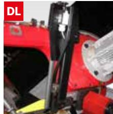
Dispositivo controllo deviazione lama (CNC)
