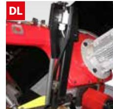
Dispositivo controllo deviazione lama (CNC)
