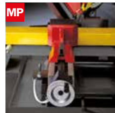
MP Morsa pneumatica Pneumatic vice
